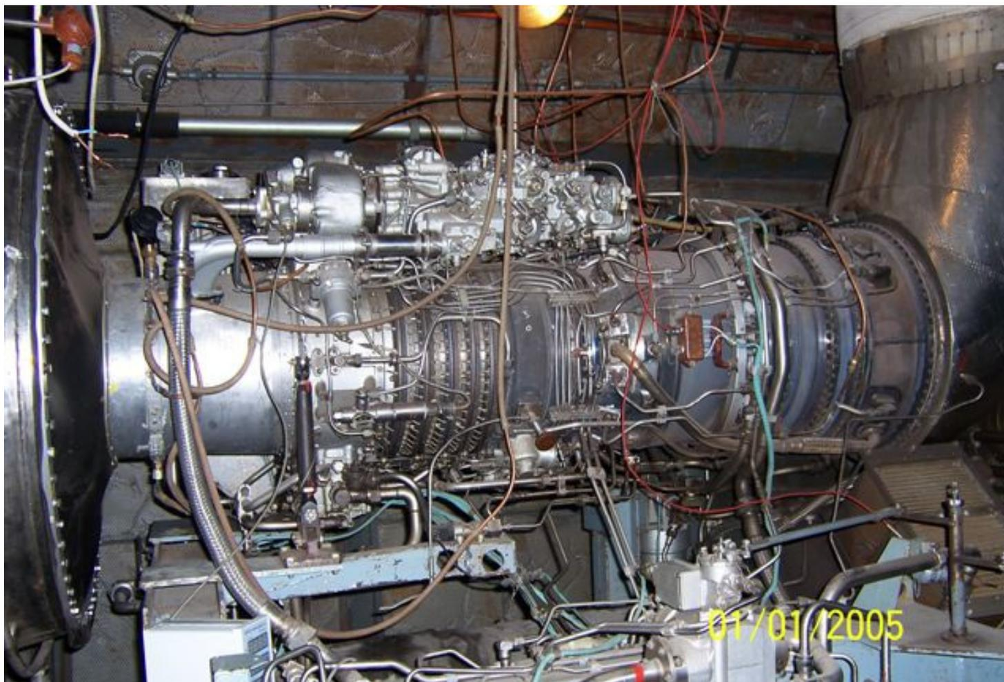
Рис. 1.2. Общий вид турбины ГТД ТВ3-117
