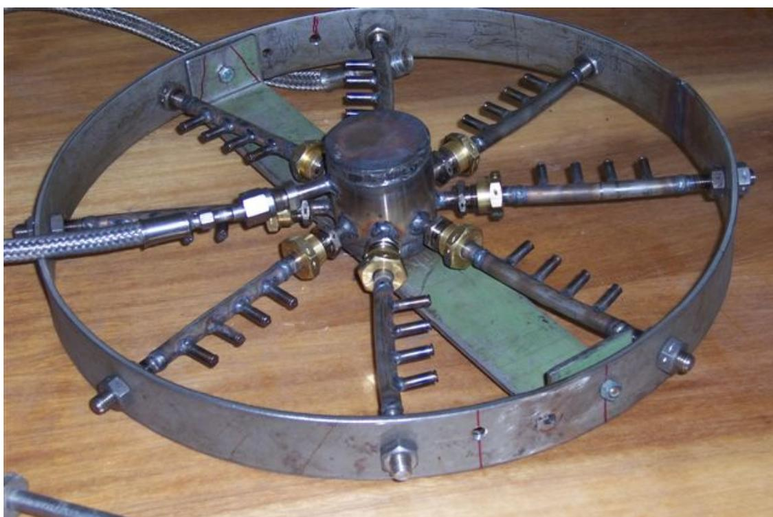
Рис. 1.5. Компоновка струйных форсунок системы впрыска перегретой воды во входную камеру ГТД
